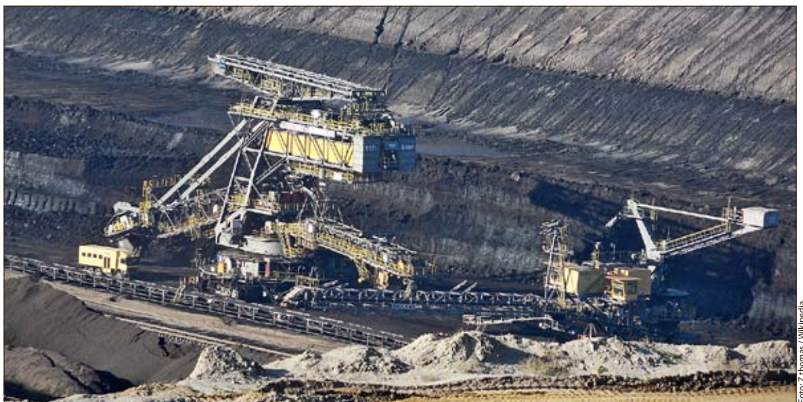
Schaufelradbagger 1532 SRs 1301 (vom Förderanlagenbau Magdeburg) mit Bandwagen 732 BRs 1400 im Tagebau Welzow-Süd – einem der LEAG-Standorte
